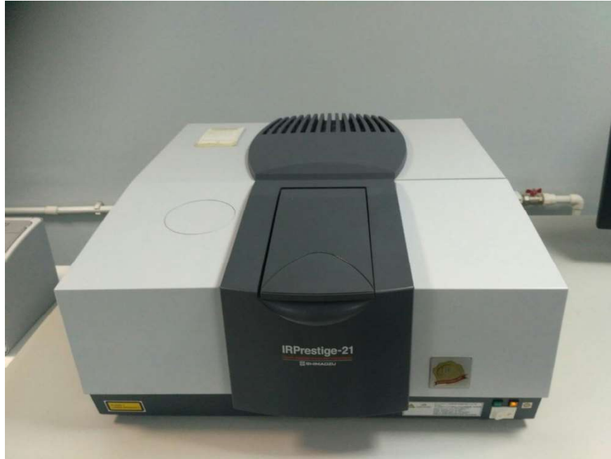
Зураг 3.6. Фурье хувиргалттай нил улаан туяаны спектроскоп FTIR (Shimadzu IR Prestige 21 FTIR).
