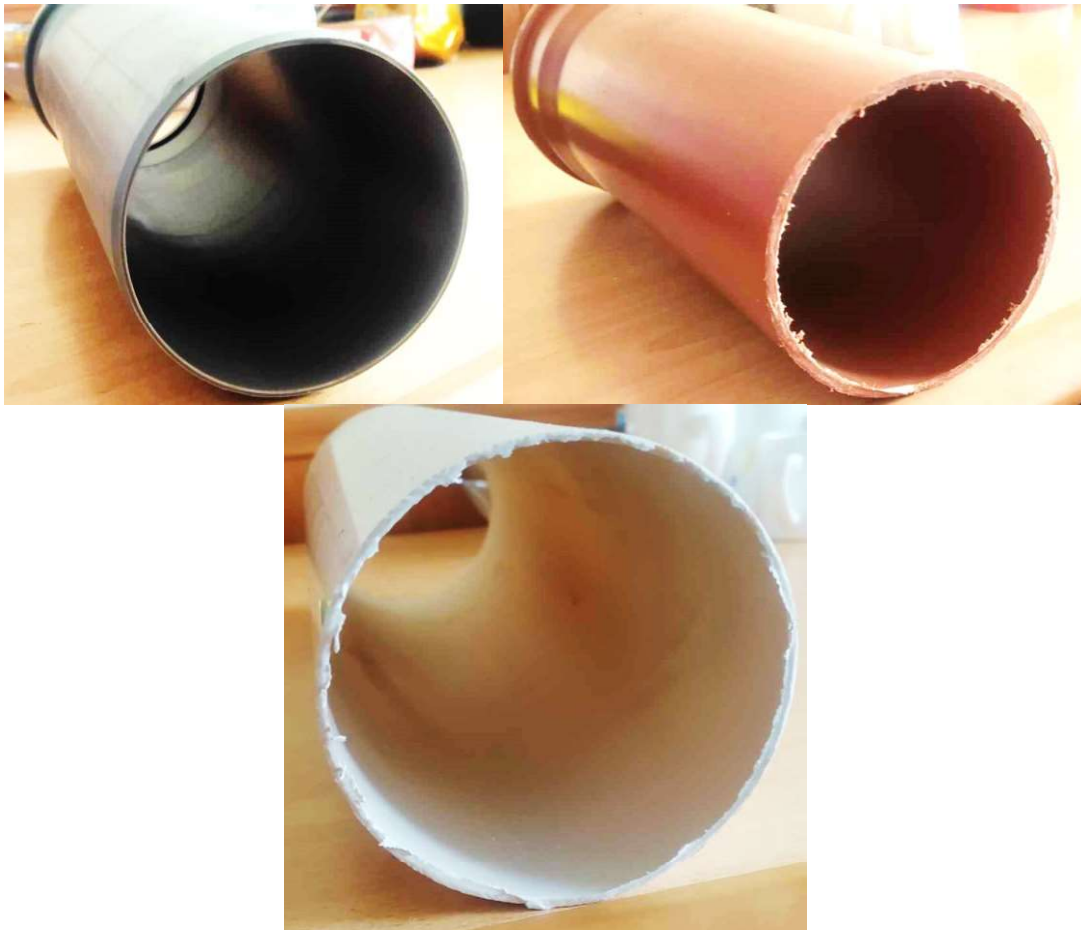
Figure 4.11 30 хоногийн турш усанд байлгаж температурын өөрчлөлтөд орсон PVC хоолойнууд.
