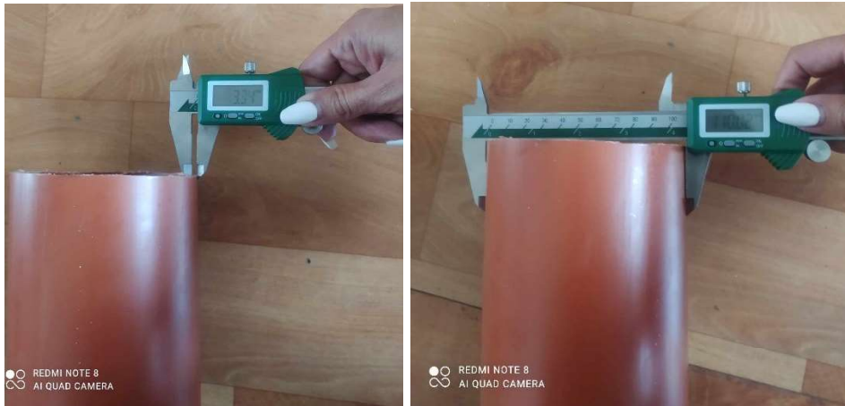
Зураг 3.4. Улбар шар PVC хоолойн хэмжээг баталгаажуулсан байдал.
