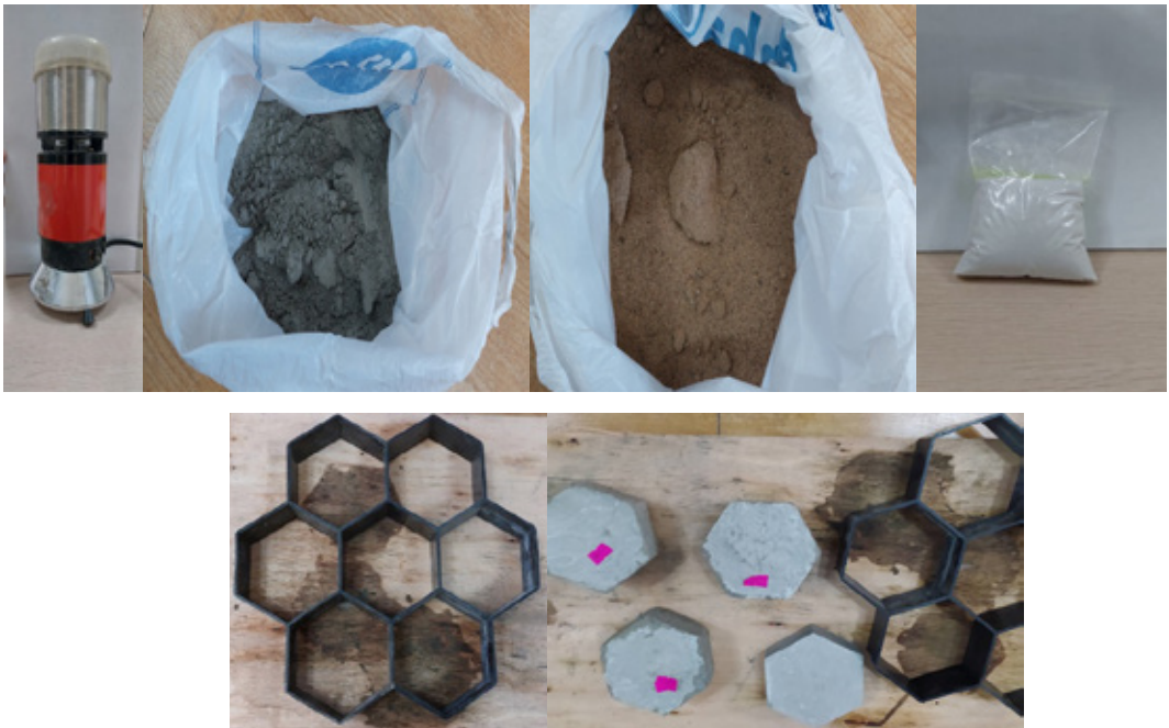
Зураг 14. Бетон дээж гарган авах туршилт.
