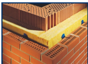
Внутри кирпичной кладки (колодцевая кладка)
