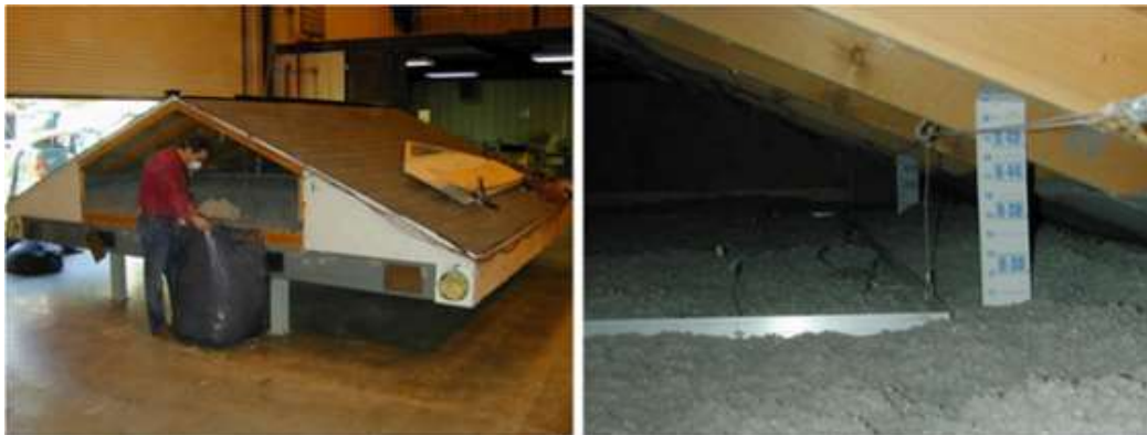
图 24 实验包含把 PCM 阁楼模块与纤维素装入微型胶囊的混合绝缘
