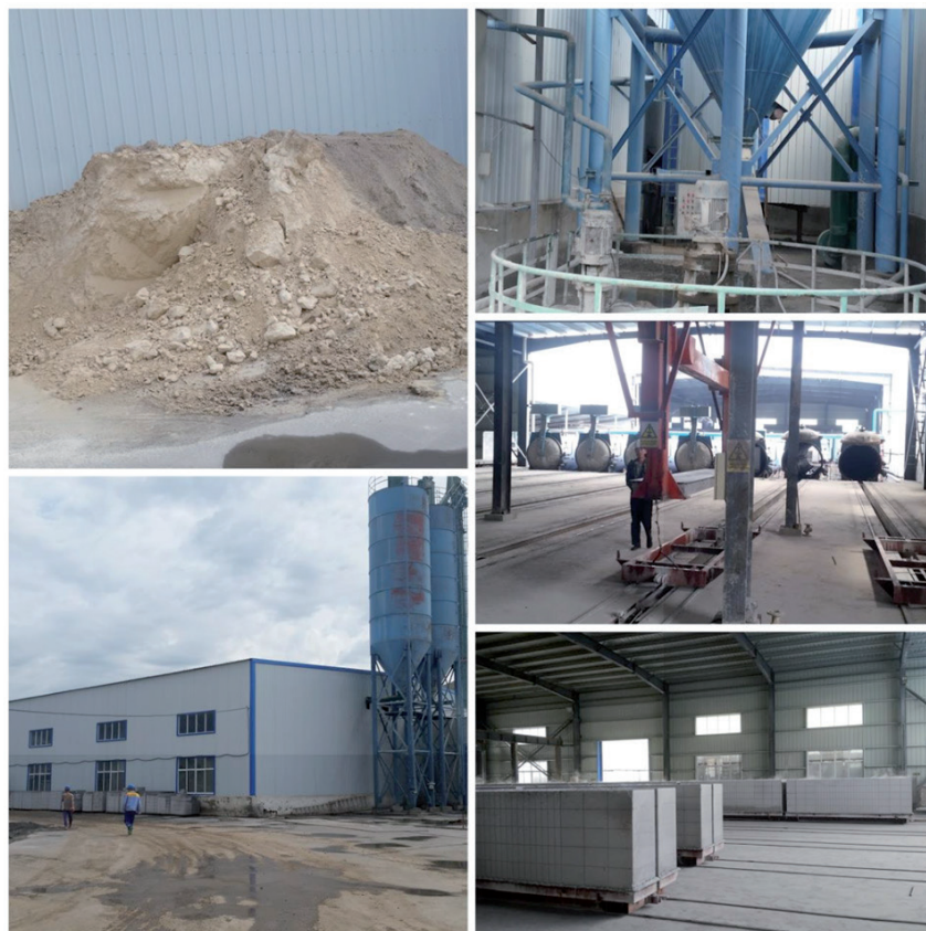
Зураг 20 Блок хийхэд үнс оруулан үйлдвэрлэж буй үйлдвэр
