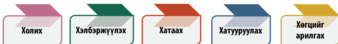
Зураг 19 Үнсэн блок үйлдвэрлэх процесс
