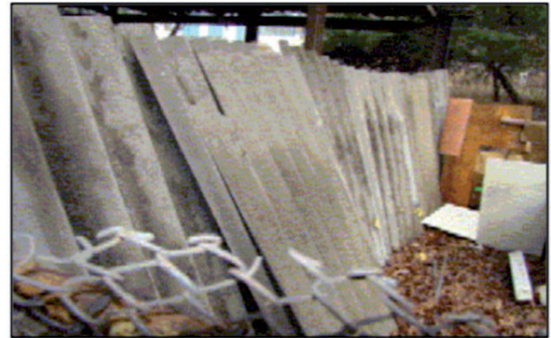
В. Дээврийн асбестан хавтангуудыг хадгалж буй байдал
